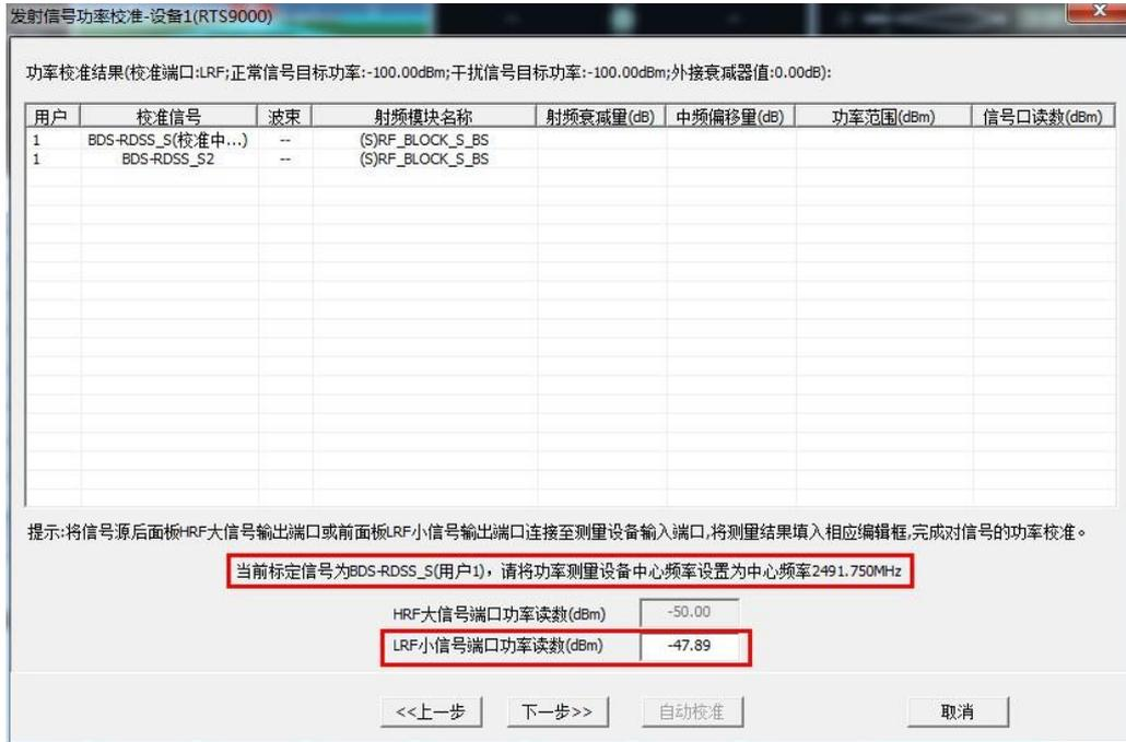
图 4-6 校准数据输入界面
